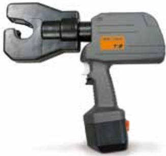
该压接工具经过高达75kV的电压测试，适用于任何符合ANSI C199.4规范连接器 — 最大500 kcmil。
