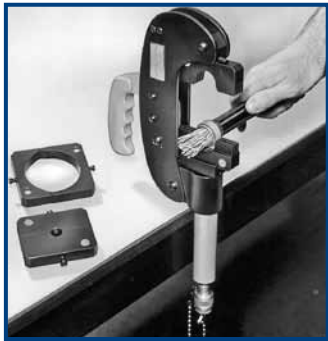
圆形系列的所有两件式Shield-Kon® 端头均须使用带适当模具的13640液压压接头进行压接。
